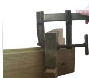
Redirected board • Tabla redirigida • Madrier redressé • neu ausgerichtetes Brett • Tavola riposizionata • Rechtgebogen plank • Tábuas redirigida
