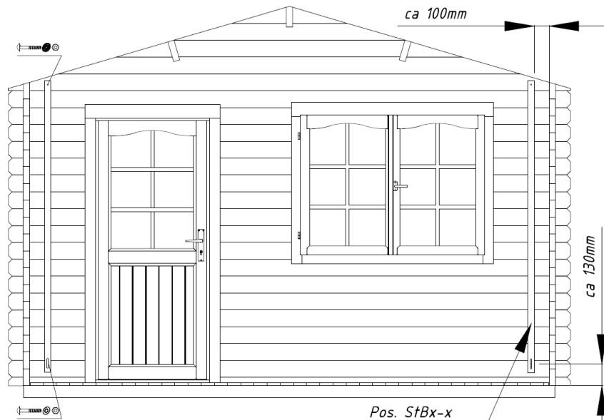
Montering av stormavstivere:
