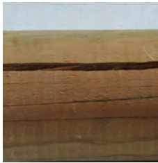
Cracks/Grietas/Fente/Risse/ Crepe/ Barsten/Fendas
