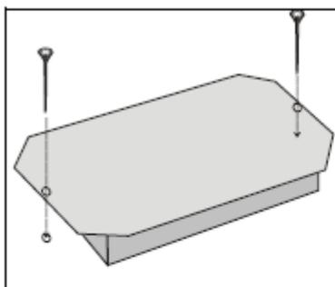
La commande est montée en dehors de la cabine, sur le toit.
