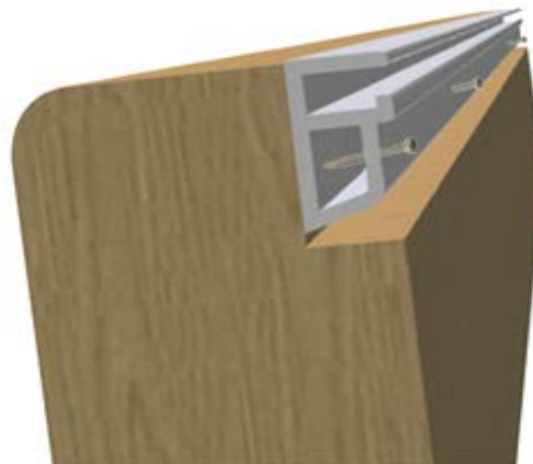
Figure 31 – Pose du rail d'accrochage
