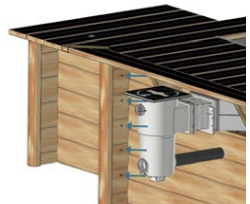
Figure 64 – Fixation du coffre sur le bassin
