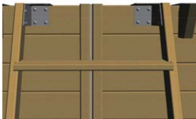
Figure 18 – Fixation de l'escalier extérieur sur le bassin
