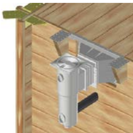
Figure 25 – Montage de l'équerre de skimmer
