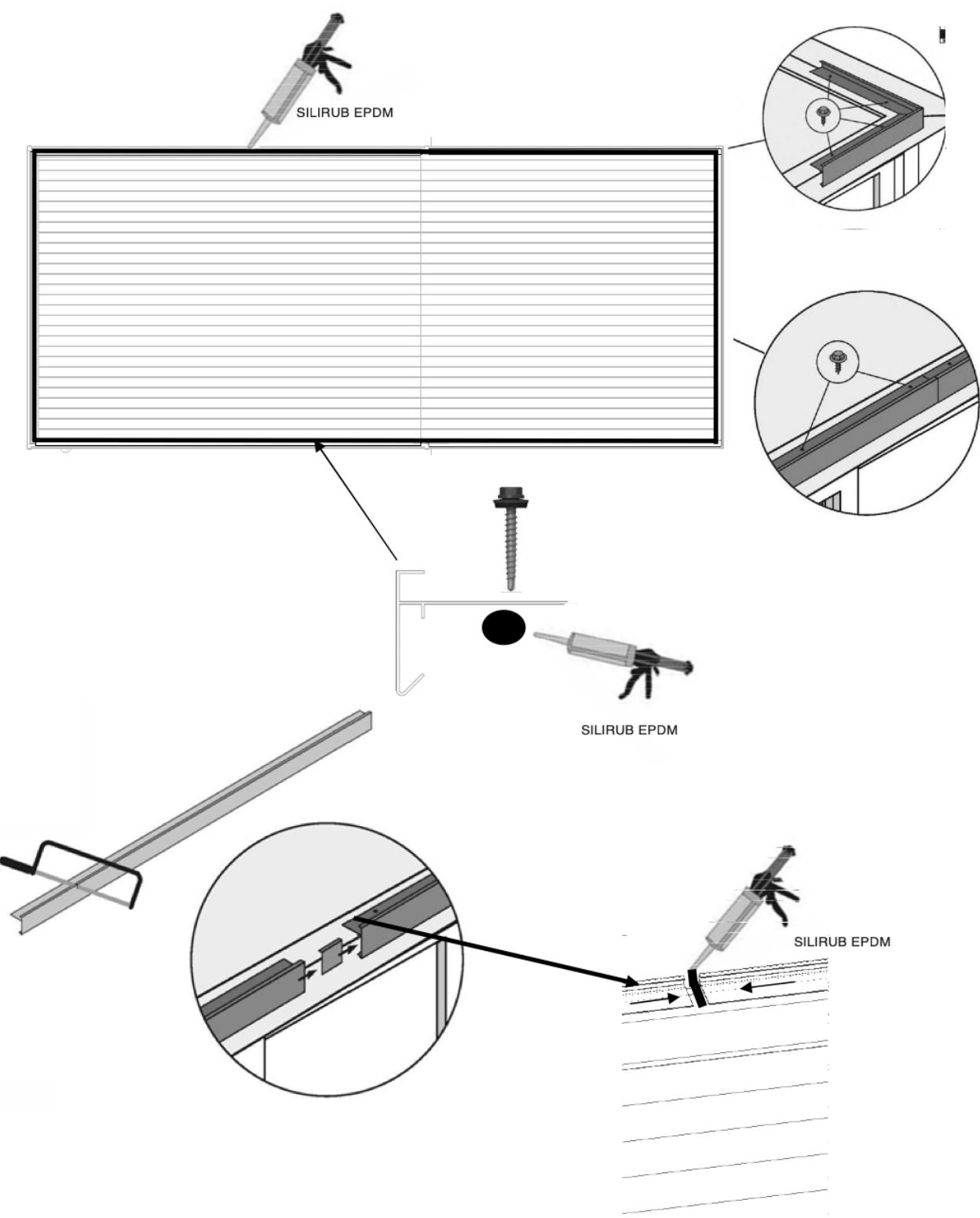
Snij de extra EPDM over de kanten weg met behulp van een mes, zonder de waterdichting daarmee in gevaar te brengen. Eliminez les feuilles EPDM extras sur le contour du toit en utilisant un couteau, sans déteriorer le colmatage de l'eau.
